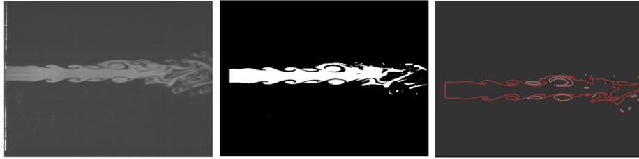
FIGURE 4 – Analyse des jets d’air turbulents par traitements d’images
