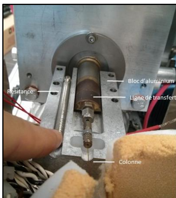
FIGURE 2.7 – Photo prise de la connexion entre la colonne de chromatographie du TAG et la ligne de transfert.
