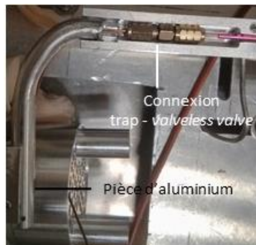
FIGURE 2.14 – Photo prise de la pièce d'aluminium incurvée qui conduit la chaleur autour de la ligne entre le trap et la valveless valve.
