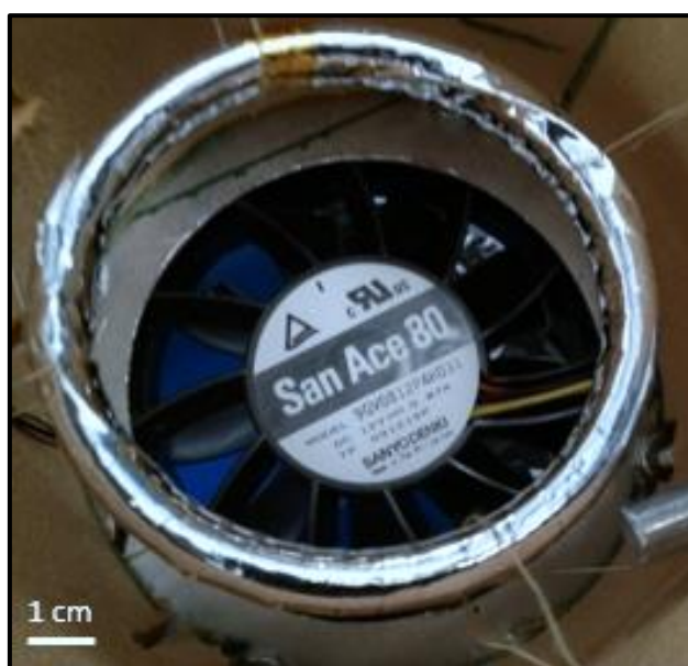
FIGURE 2.5 – Photo prise du fastGC et du ventilateur du système TAG du LCE. La colonne entourée sur elle-même le long d'un fil en nickel est recouverte d'une feuille en aluminium. L'ensemble est maintenu droit au-dessus du ventilateur par 4 fils en polymère résistant aux hautes températures (Restek).
