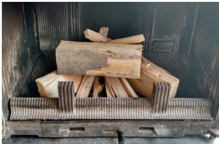
FIGURE 2.20 – Exemple de mise en place type du foyer dans le cas du modèle de poêle à bûches ancien Cheminées Gaudin.
