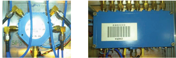
FIGURE 4.30 – Commutateurs pour les voies de réception SP8T (gauche) et pour les voies d'émission SP4T (droite).
