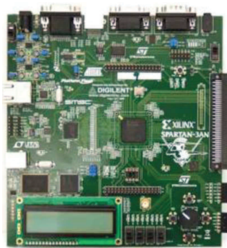
FIGURE 4.31 – Représentation du module de commande formé par une carte FPGA Spartan 3AN de Xilinx.
