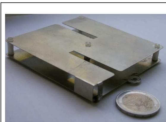
Figure 144 : Prototype de l'antenne PIFA à fentes débouchantes
