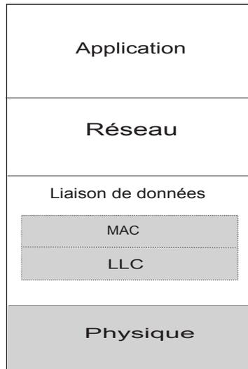
**Figure 1.3:** Pile protocolaire pour les réseaux de capteurs sans fil
