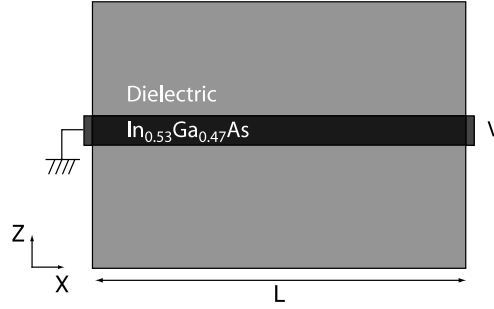
Figure 3.28 – Dispositif considéré dans la simulation MC des canaux 2D. La couche d' \text{In}_{0.53}\text{Ga}_{0.47}\text{As} est enrobée dans un diélectrique.
