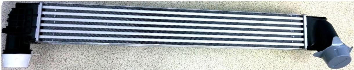
**Figure 80 – Refroidisseur d'Air Suralimenté rectangulaire**
