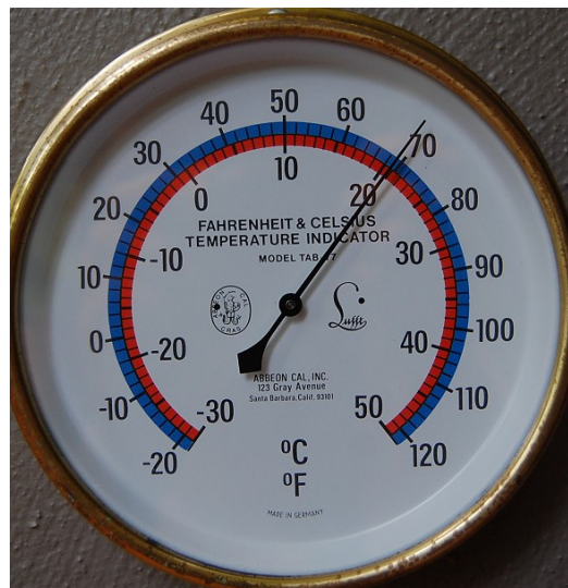
Illustration 6: thermomètre canadien à double graduation °C et °F
