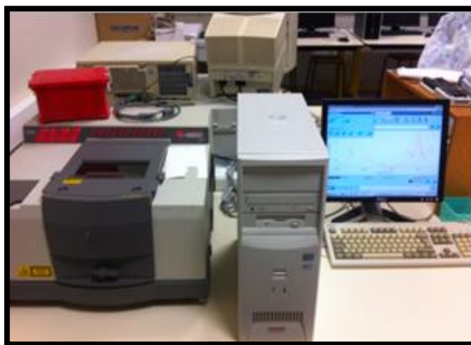
Figure 2. 24 Spectromètre infrarouge (à gauche) et collecte des données sur le logiciel OMNIC.
