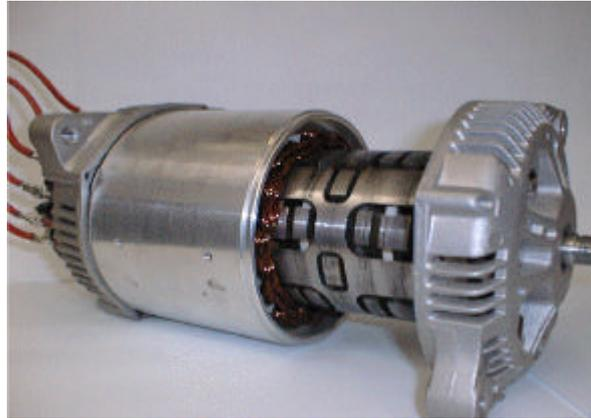
*c) vue du stator et rotor ensembles*
