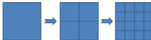
Figure 62: Subdivision récursive d'un territoire quatre par quatre pour la mise en place d'un quadtree.
