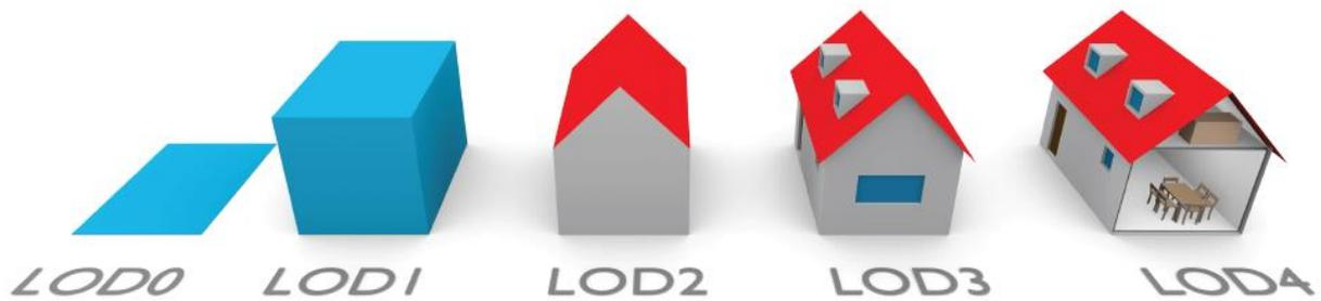
Figure 19 : 5 LoDs des bâtiments définis dans le standard CityGML. (Image issue de de [BLS16b])
