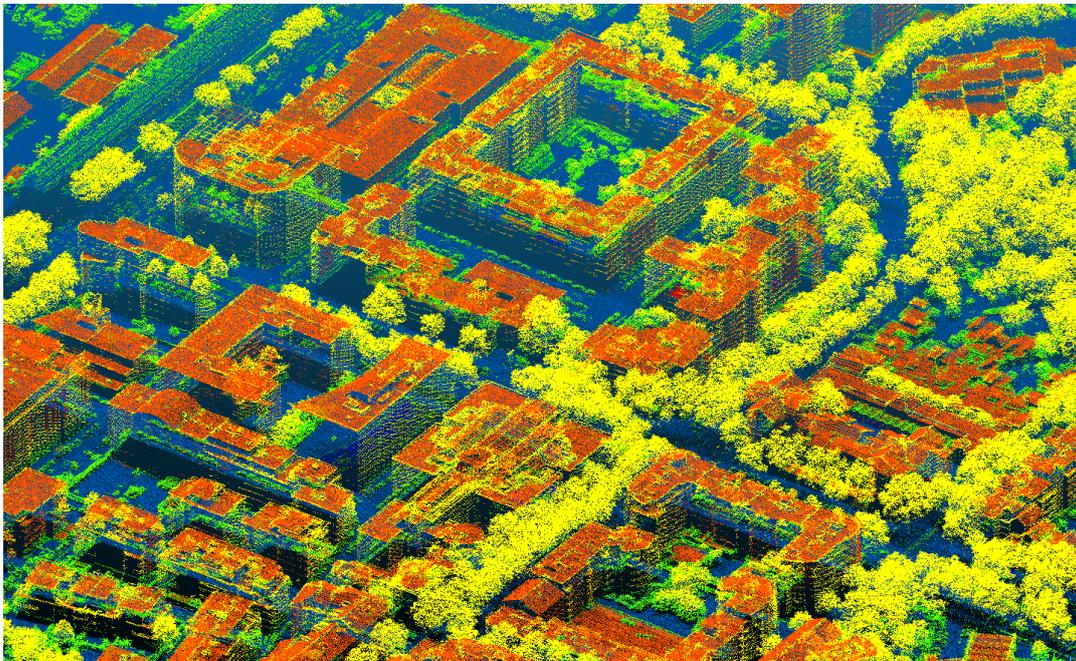
Figure 5 : Nuage de points LiDAR aérien du 6<sup>ème</sup> arrondissement de la ville de Lyon acquis en 2015 avec une densité de 12 points/m<sup>2</sup>. Les différentes couleurs (arbitrairement définies ici) correspondent aux classifications des points présentes dans le LiDAR. Par exemple, la végétation est ici en jaune alors que les surfaces artificielles sont en orange. (Données issues du site de la Métropole de Lyon<sup>23</sup>)
