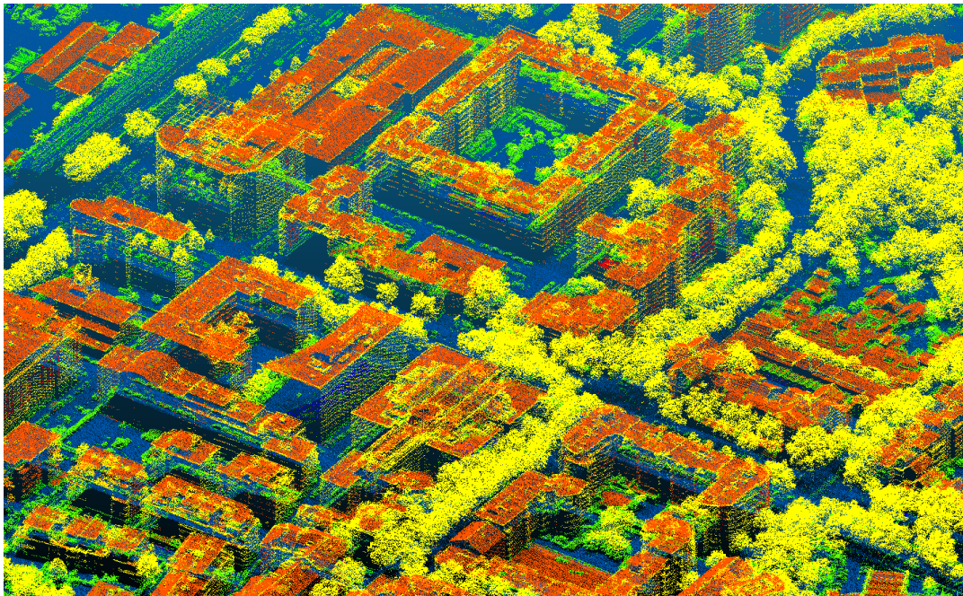
Figure 5 : Nuage de points LiDAR aérien du 6 ème arrondissement de la ville de Lyon acquis en 2015 avec une densité de 12 points/m 2 . Les différentes couleurs (arbitrairement définies ici) correspondent aux classifications des points présentes dans le LiDAR. Par exemple, la végétation est ici en jaune alors que les surfaces artificielles sont en orange. (Données issues du site de la Métropole de Lyon 23 )
