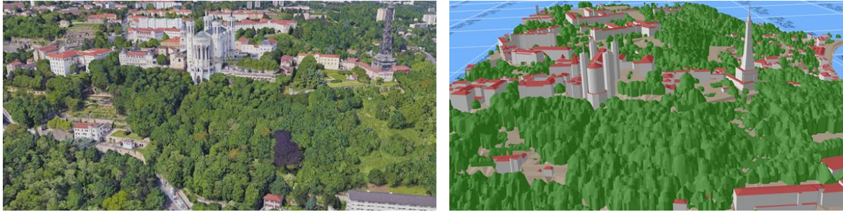
Figure 55: Résultat de la génération d'un modèle 3D de végétation (à droite) sur la colline de Fourvière à Lyon. Comparaison avec la modélisation proposée dans Google Earth à gauche.
