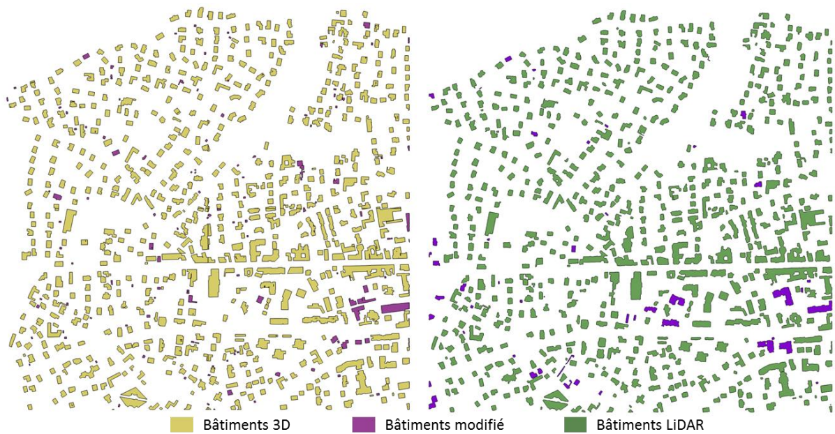
Figure 88: Comparaison de bâtiments entre un modèle 3D et un nuage de points LiDAR, sur la zone de Craonne entre 2012 et 2015.
