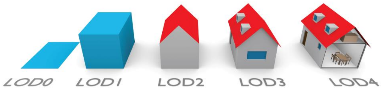
Figure 19 : 5 LoDs des bâtiments définis dans le standard CityGML. (Image issue de de [BLS16b])
