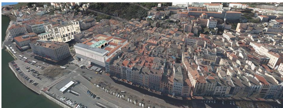
Figure 25: Une vue du modèle 3D de la ville de Lyon, composé d'un MNT et de bâtiments LoD2 texturés.
