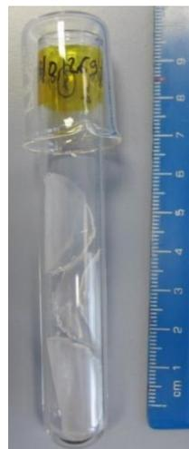
Figure II-33 - Préparation des films de PURe avant irradiation. À gauche : films obtenus après évaporation du tétrahydrofurane, à droite : tube à essai contenant les films de PURe juste avant irradiation.
