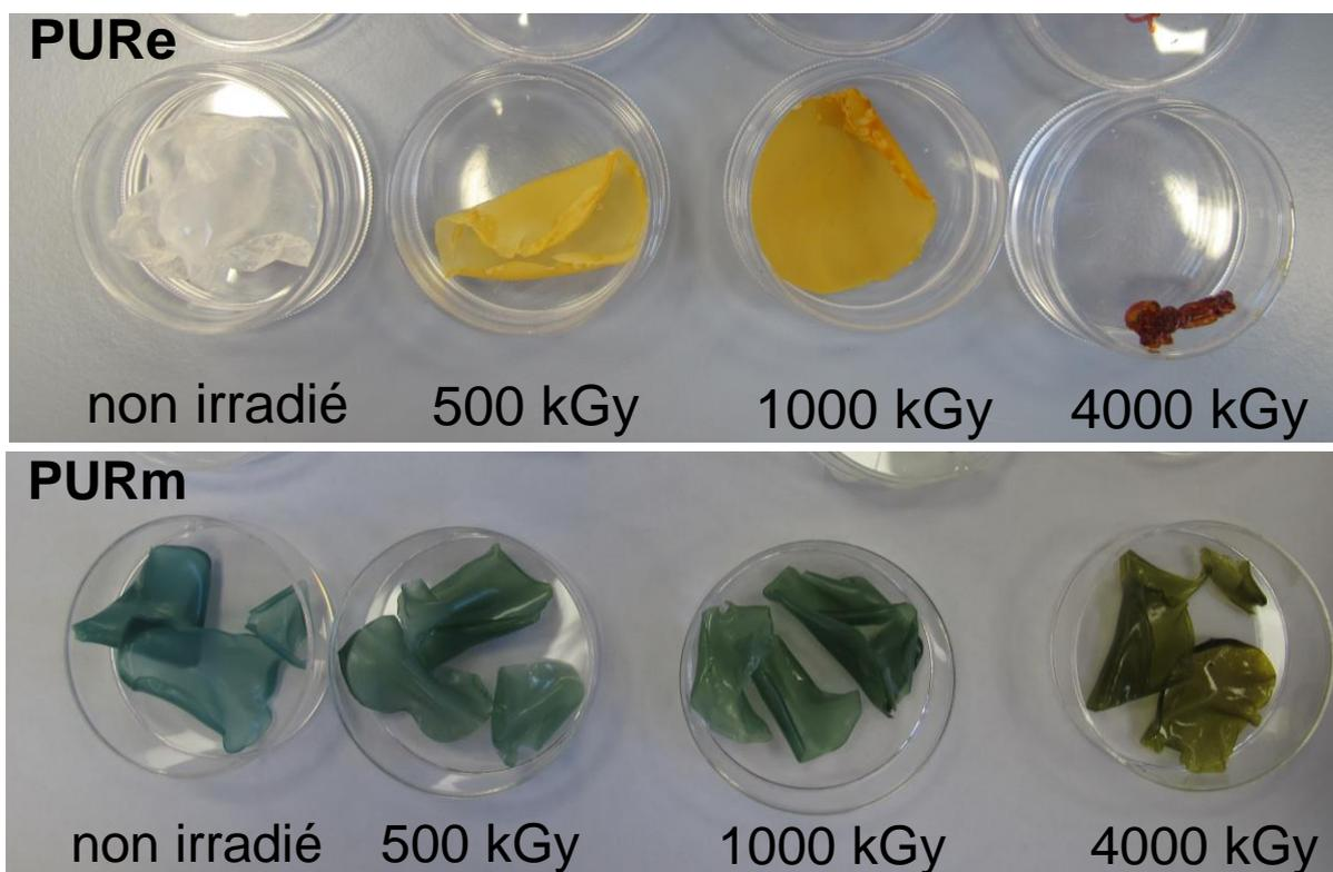
Figure II-34 - Photographie du PURE (haut) et du PURm (bas) en fonction de la dose d'irradiation (les films de PURm présentés ici ont été pressés à chaud avant irradiation afin de réduire leur épaisseur).
