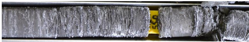
Fig. VII.6: Photographie d'une section de carotte du forage C050043 à -55 m montrant un faciès très altéré sur lequel les mesures niton sont peu fiables.
