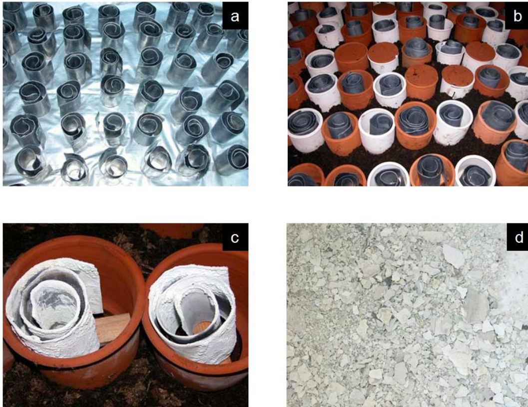
Figure III. 19: Étapes de la fabrication du blanc de plomb commercial issu d'un procédé d'empilement (a) : rouleaux de plomb métallique, (b) : strate de jarres contenant les rouleaux et prêtes à être recouvertes de fumier, (c) : rouleaux corrodés lors de l'ouverture des jarres après 4 mois de corrosion, (d) : pigment obtenu (on constate que le produit s'est détaché sous forme d'écailles). © Natural Pigments
