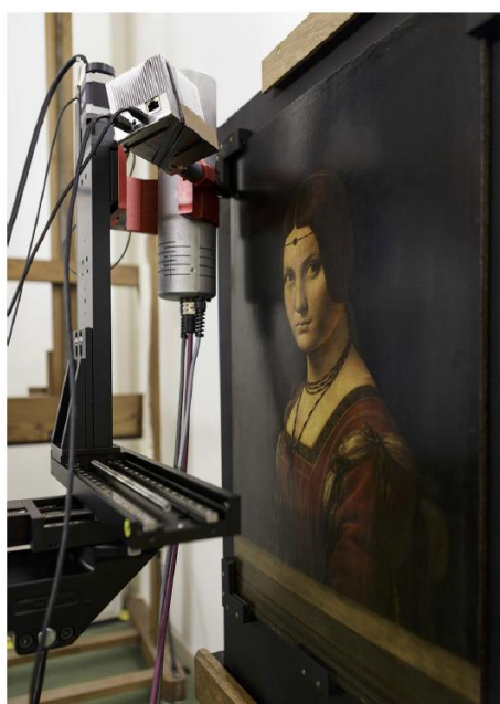
Figure IV. 2 : Analyse par MA-XRF de la Belle ferronnière au C2RMF.
