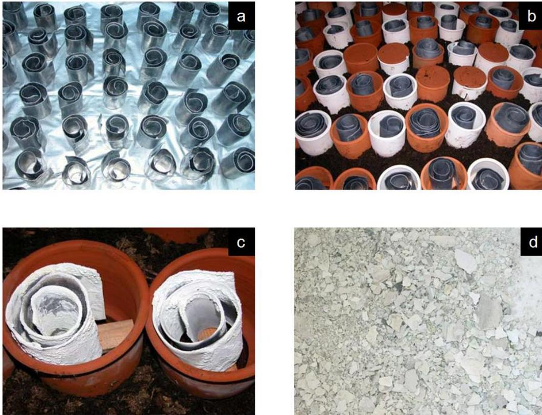
Figure III. 19: Étapes de la fabrication du blanc de plomb commercial issu d'un procédé d'empilement (a) : rouleaux de plomb métallique, (b) : strate de jarres contenant les rouleaux et prêtes à être recouvertes de fumier, (c) : rouleaux corrodés lors de l'ouverture des jarres après 4 mois de corrosion, (d) : pigment obtenu (on constate que le produit s'est détaché sous forme d'écaillés). © Natural Pigments
