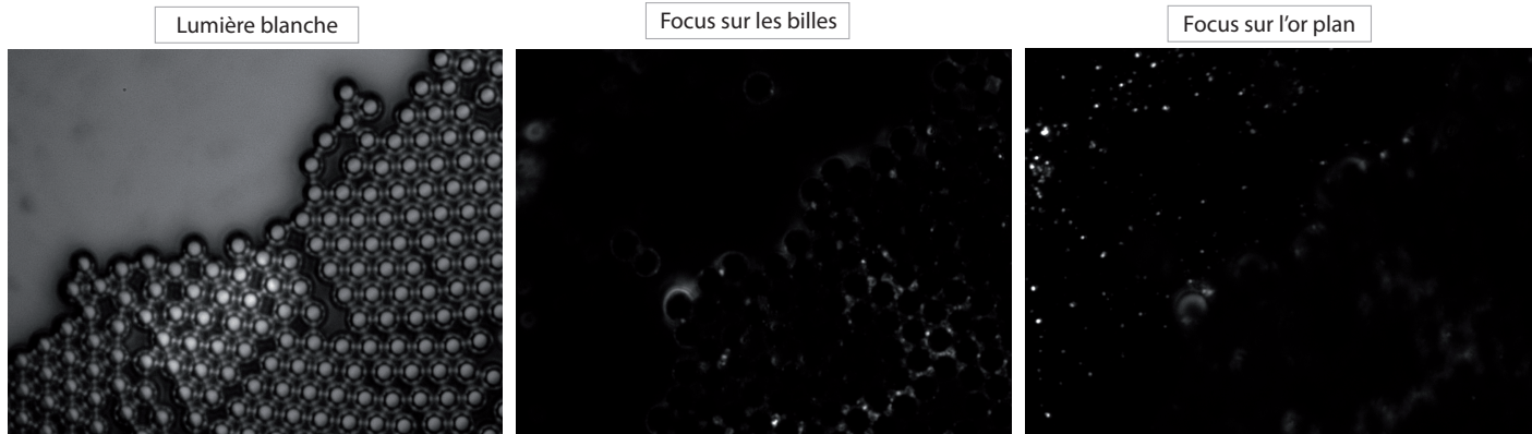
FIGURE 5.8 – Images de microscopie par fluorescence (100x) de nanocristaux de CdSe/CdS hydrophobes déposés sur une monocouche de billes de polystyrène de 5\mu\text{m} de diamètre recouverte d'or rendue hydrophile. Le focus n'est pas le même sur les deux images : à gauche le focus est fait sur le sommet des billes et à droite il est fait sur l'or plan plus bas.
