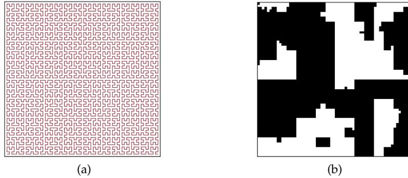
FIGURE 4.1 – (a) Parcours de Hilbert-Peano permettant de former une image à partir d’une chaîne de Markov de  $64^2$  variables. (b) Réalisation d’une chaîne de Markov de  $64^2$  variables, à deux classes, reformées en image selon un parcours de Hilbert-Peano. Ce type de procédure peut être généralisé au cas 3D [Bricq et al., 2006].
