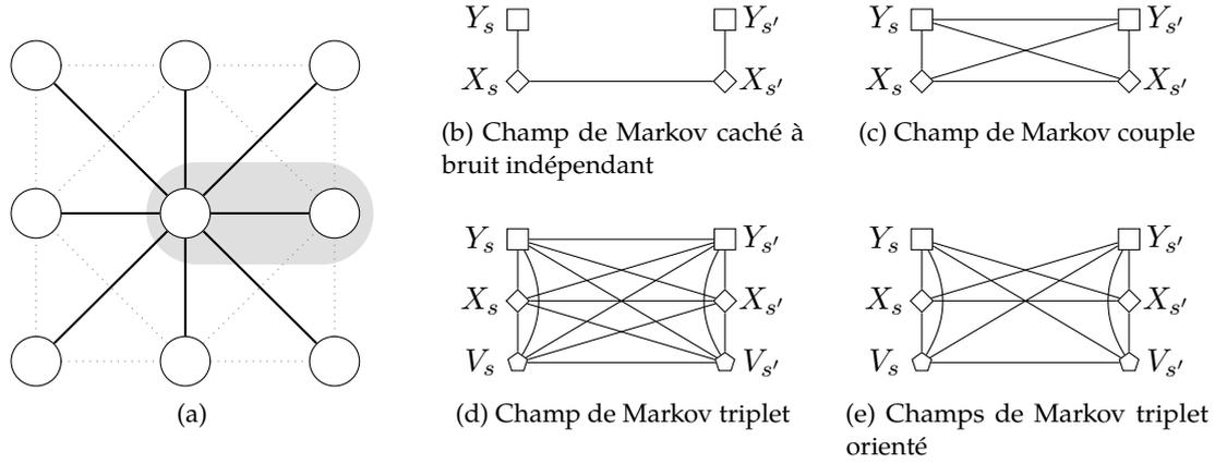
FIGURE 6.1 – Graphe de dépendances pour un champ de Markov. (a) Dépendances d'un champ de Markov au sein des 8 voisins d'un site  $s$ . Les connections en pointillés représentent les liens ne concernant pas  $s$  directement. (b-e) Sous-graphes pour les liens entre le site central et un site voisin  $s'$  (région grisée de (a)) dans les modèles de champ de Markov caché à bruit indépendant, couple, triplet et triplet orienté.
