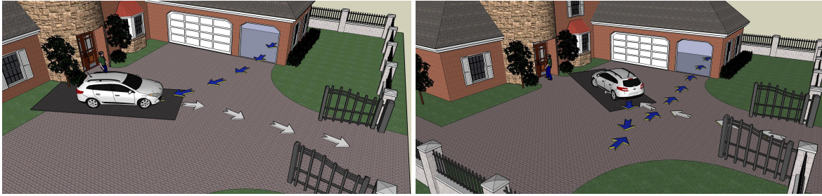
FIGURE A.1: Exemple graphique du système Autonomous Valet Parking . (A gauche) Situation de départ du domicile, où le véhicule doit sortir du garage, (à droite) situation d'arrivée au domicile, où le véhicule doit se garer dans le garage. Les flèches bleues correspondent à la trajectoire du véhicule faite de manière autonome et les flèches blanches à la trajectoire réalisée par le conducteur. (source de l'image : [Chirca et al., 2015a])
