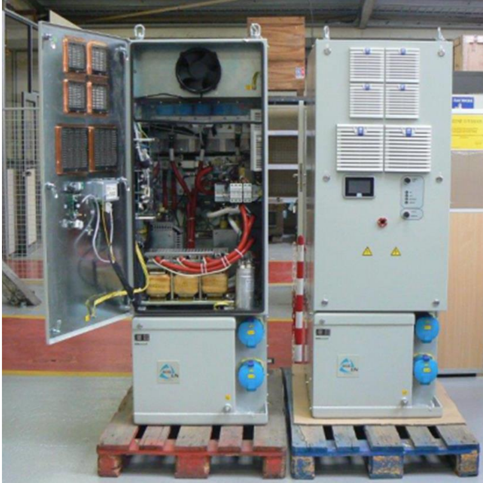
Figure 33 – Vue de l'intérieur et de l'extérieur de l'onduleur triphasé d'une puissance de 60kVA développé par l'industriel ECA GROUP
