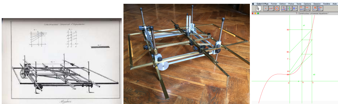
Figure 18. Illustration du constructeur universel d'équations de Segner dans l'Encyclopédie de Diderot et d'Alembert (à gauche). Au centre, la machine fonctionnelle jusqu'au degré 3 construite en 1994 par R. Bellemain (collection privée). A droite, une simulation informatique réalisée avec Cabri-géomètre (Carral & Cuppens, 1993).
