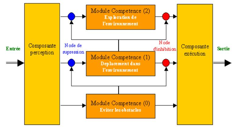
FIG. 3.4 – Un exemple de l'architecture de subsumption.
