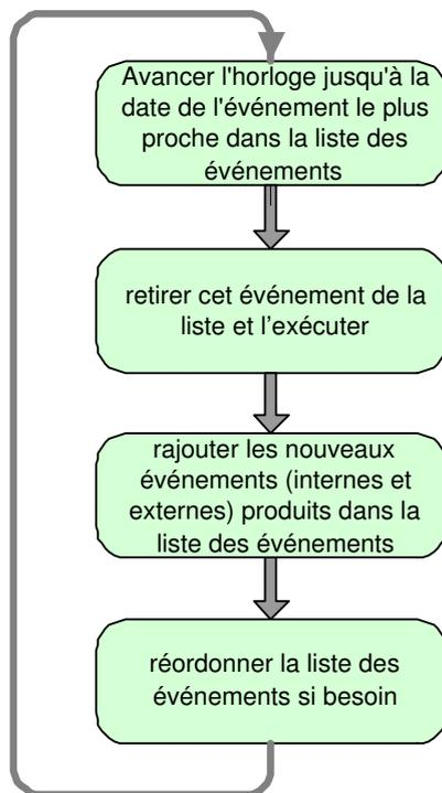
FIG. 2.8 – Principe de simulation par ordonnancement d'événements.
