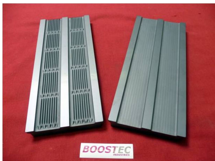
FIGURE 6.33 – Photo des deux demi-coques en céramique constituant le module solaire avant le brasage.
