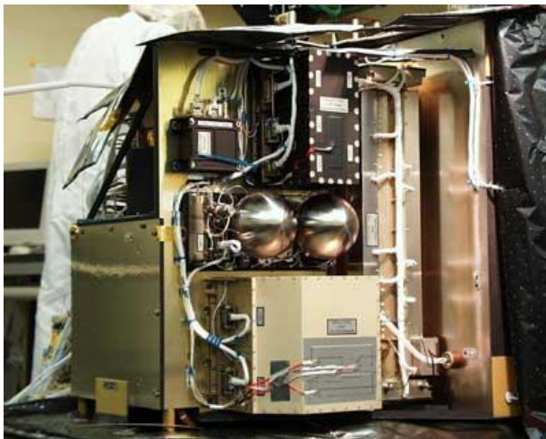
Figure 32 : Photos de l'expérience COSAC intégrée dans l'atterrisseur Philae (à gauche) et du chromatographe en phase gazeuse avec ses 8 modules analytiques (à droite)
