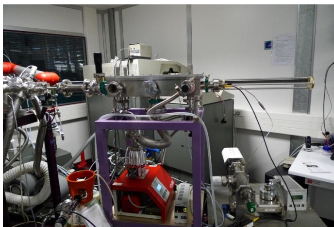
Figure 17 : Photo du réacteur APSIS couplé à la ligne DISCO du synchrotron SOLEIL
