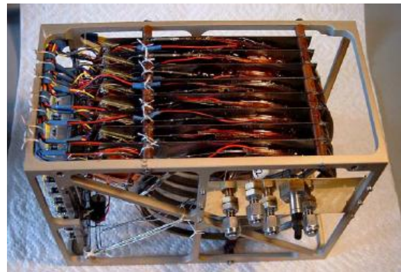
Figure 32 : Photos de l'expérience COSAC intégrée dans l'atterrisseur Philae (à gauche) et du chromatographe en phase gazeuse avec ses 8 modules analytiques (à droite)
