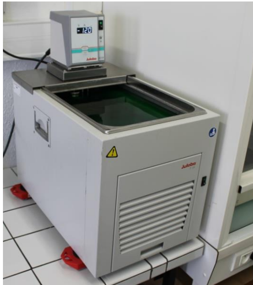
Figure 38 : Cryostat utilisé lors de la méthode du « drop freezing » dans cette thèse. Le liquide à l'intérieur du cryostat est de l'éthylène glycol, un antigel utilisé dans les systèmes de refroidissements automobiles.
