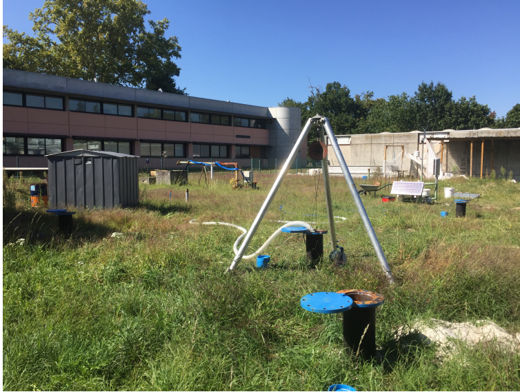
FIGURE 5.10: Mise en situation d'un essai de nappe sur la station expérimentale
