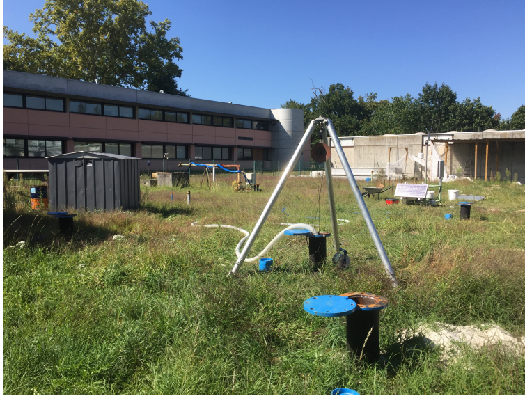
FIGURE 4.10: Mise en situation d'un essai de nappe sur la station expérimentale
