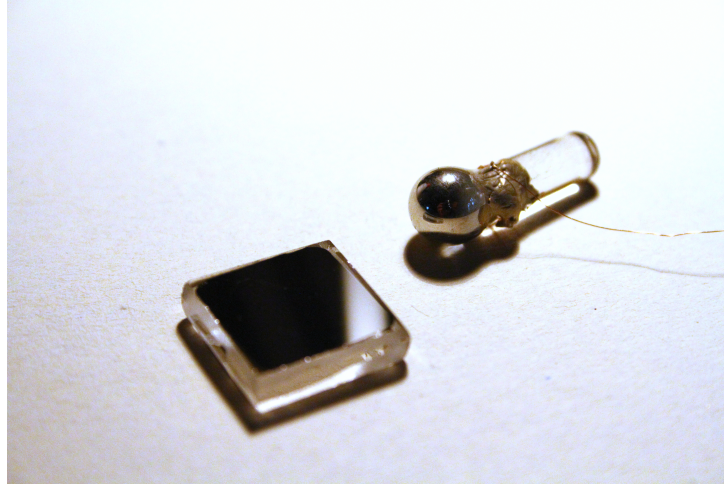
FIGURE B.4 – Photographie de la sphère et du plan métallisés. On observe la colle époxy conductrice qui permet de relier le fil de cuivre fin à la sphère.
