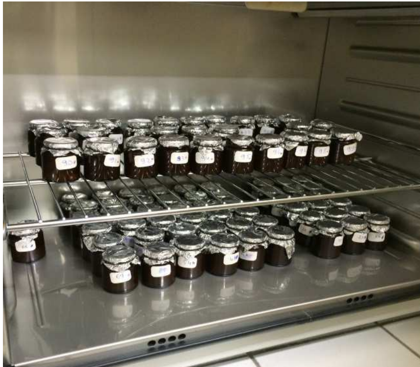
Photo IV-3 : Photo d'incubation lors de l'étude microcosme de bioremédiation des sols contaminés par les hydrocarbures
