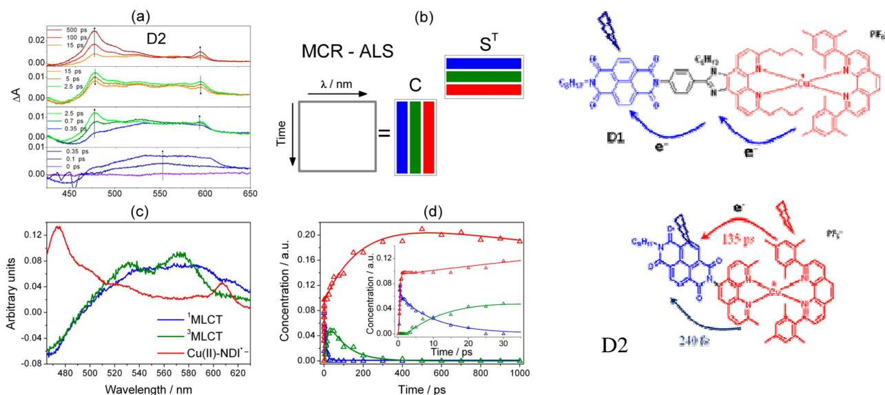
Figure 28 : Spectres d'absorption transitoire entre 0 et 300 ps de D2 après une excitation à 400 nm et profils temporels de concentration (entre 0 et 20 ps) et spectres associées obtenus par une analyse MCR-ALS. Structure des dyades D1 et D2.
