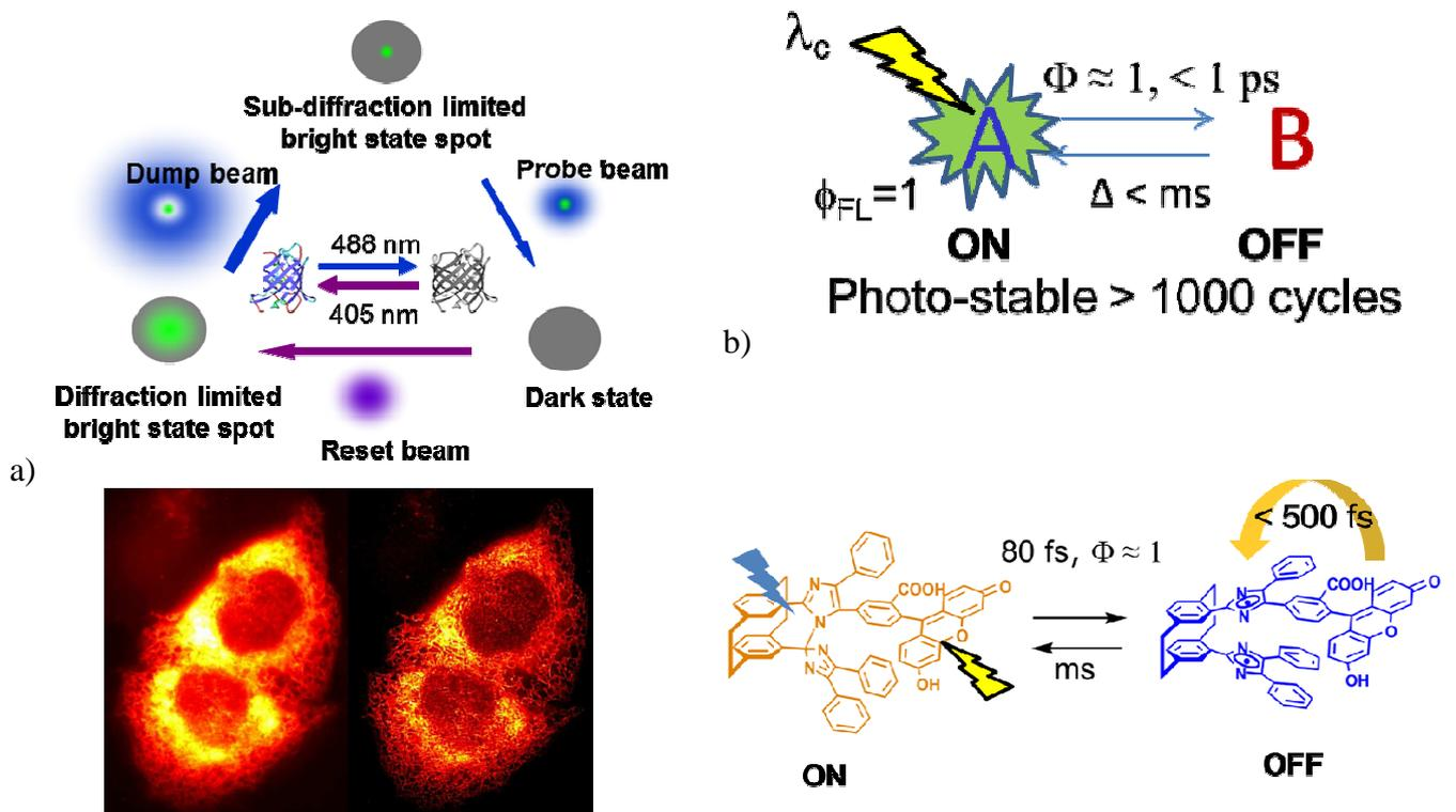
Figure 36 : b) Exemple de microscopie RESOLFT utilisant des protéines photo-réversibles [MS 14 Citation 84] et images RESOLFT utilisant la rsEGFP2<sup>51</sup> b) Propriétés photo-physiques nécessaires pour réaliser de la microscopie fs RESOLFT et exemple de molécules [MS 55 Citation 19].
