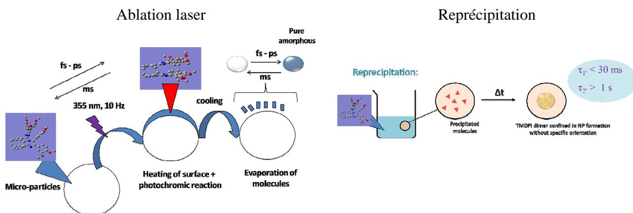
Figure 26 : Schéma des processus se déroulant lors de la synthèse de nanoparticules de Fast HABI par ablation laser et re-précipitation.
