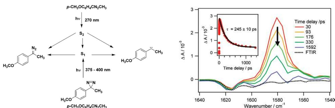
Figure 31 : Schéma réactionnel des différents chemins de désactivation de l'état excité de la *para*-methoxy-3-phenyl-3-methyl diazirine et spectre d'absorption transitoire IR de l'état singulet absorbant à 1580  $\text{cm}^{-1}$ .
