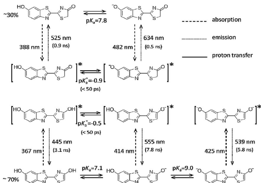
Figure 32 : Photodynamique de l'oxyluciférine en solution aqueuse.
