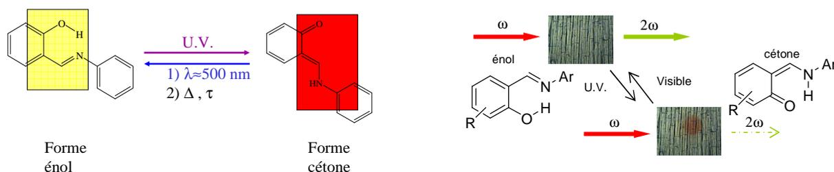
Figure. 3 : Mécanisme du photochromisme à l'état cristallin des anils entre la forme énol (jaune) et la forme cétone (orange, photo-produit). Schéma de principe de la photo-commutation de GSH.
