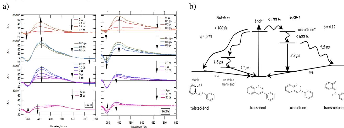
Figure 14 : a) Evolution des spectres d'absorption transitoire UV-visible entre 0 et 25 ps pour SAOH et SAOMe après une excitation à 266 nm. b) Schéma réactionnel de la photo-dynamique de SAOH après une excitation à 266 nm.
