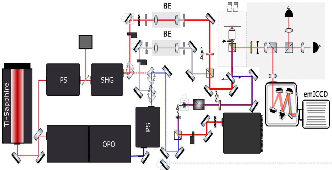
Figure 35 : Montage d'easy STED construit au laboratoire.
