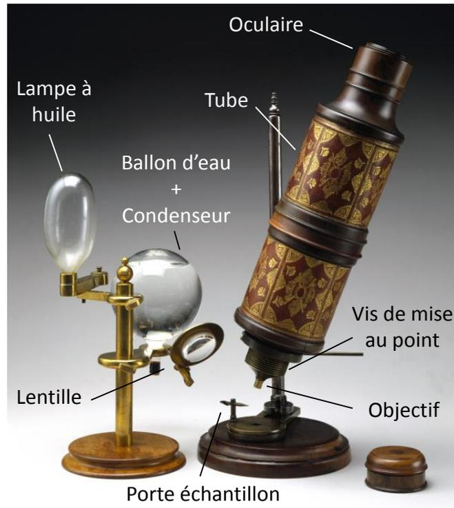
**Figure 1** : Image du microscope de Hooke, adaptée de [14].
