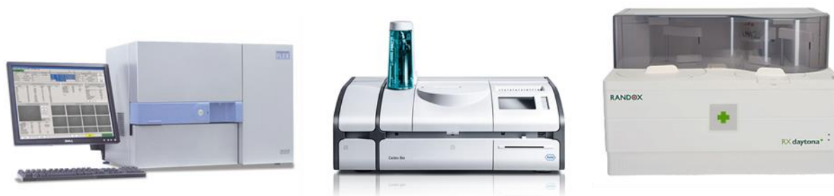
Figure 1.19 Analyseurs automatiques (de gauche à droite) Bioprofile® FLEX (Nova Biomedical), Cedex Bio (Roche CustomBiotech) et RX Daytona + (Randox) [29-31].
