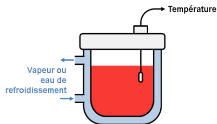
Figure 1.14 Schéma du dispositif de contrôle de la température.
