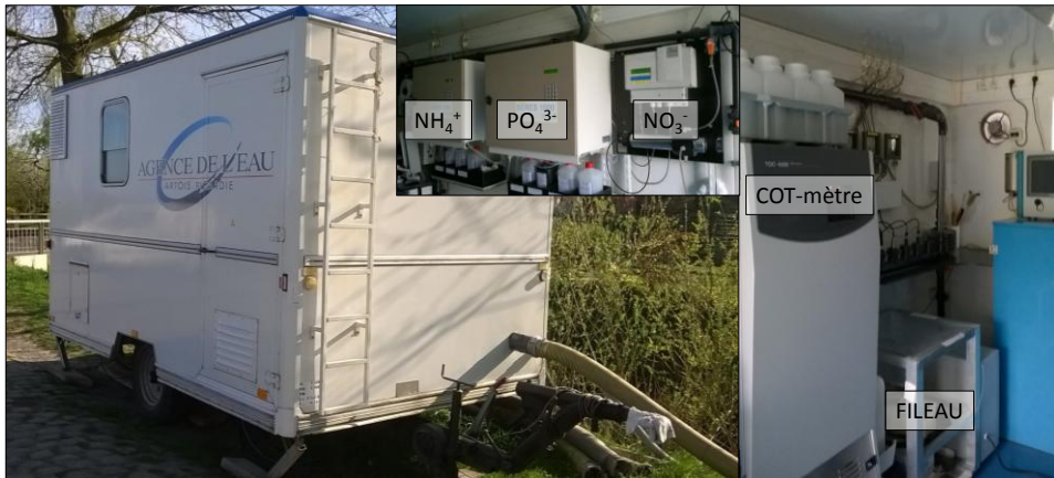
Figure 15. Station automatique de l'AEAP implantée à Tressin lors du suivi de mars-avril 2015. Intérieur de la station aval (Hempempont) avec le COT-mètre, FILEAU (préleveur-filtreur), et les appareils mesurant les nutriments.
