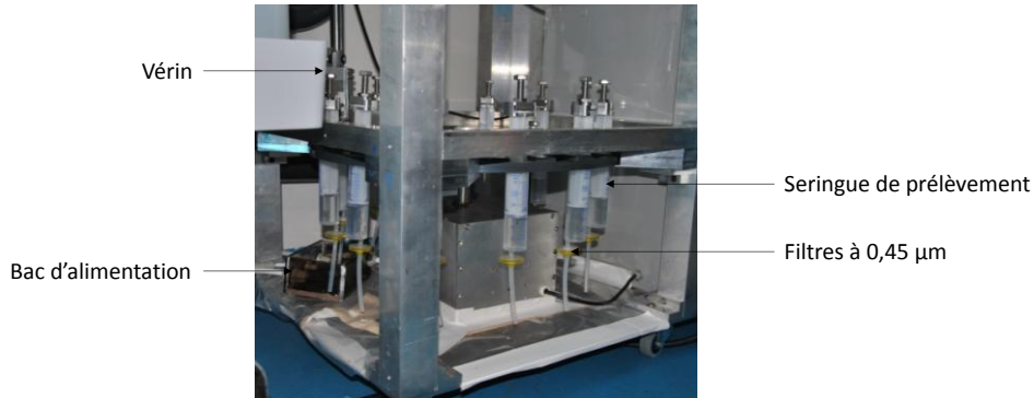
Figure 16. Photo du préleveur FILEAU, installé dans la station de mesures haute-fréquence, en aval de la zone d'étude.
