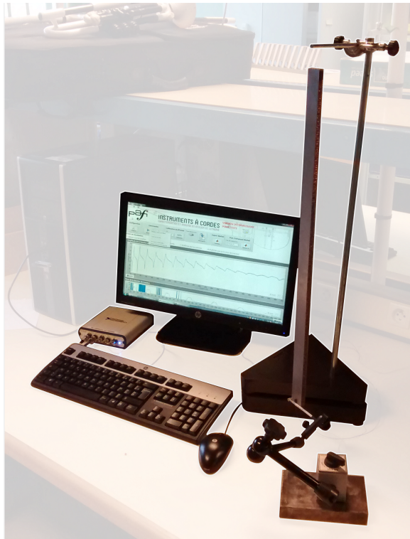
FIGURE 3.39 – Montage expérimental pour la mesure du déplacement transverse local de la poutre sandwich NIDA avec conditions limites libres. Un marteau d'impact miniature excite la structure à proximité d'un accéléromètre miniature.
