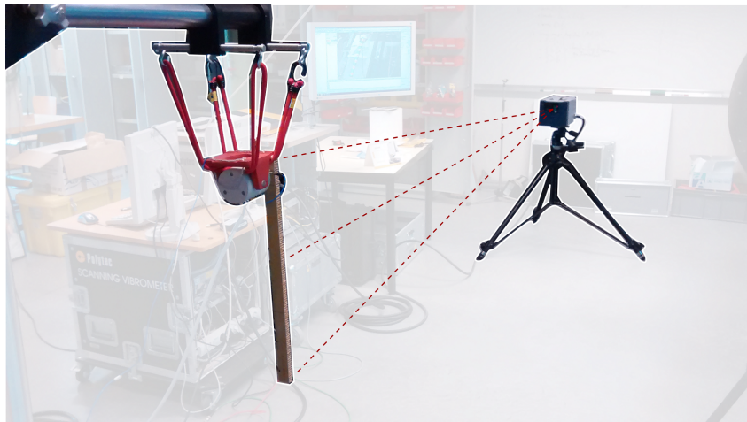
FIGURE 3.31 – Montage expérimental pour la mesure du champ de déplacement de la poutre sandwich NIDA. La structure est montée sur un pot vibrant en x_0 = 0.048 m et un vibromètre laser à balayage mesure le champ de déplacement transverse.
