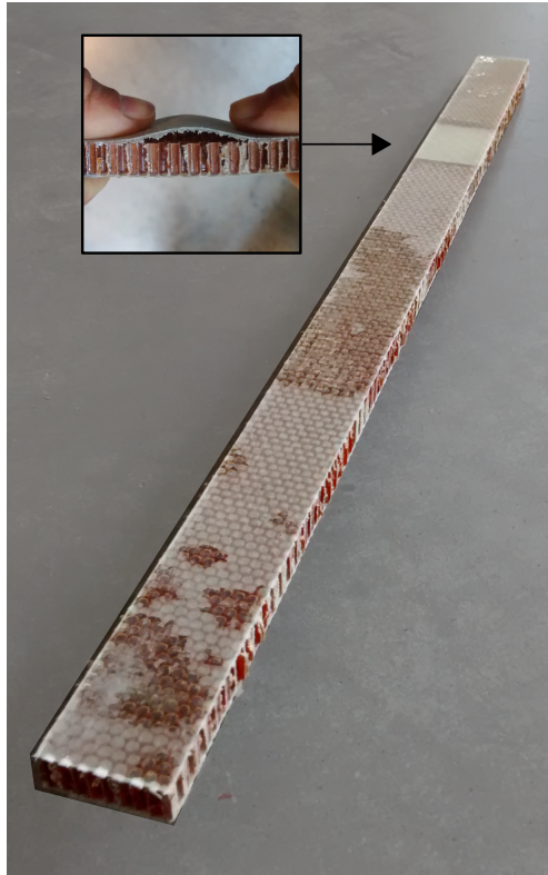
FIGURE 5.9 – Poutre composite multicouche présentant un défaut de collage.
