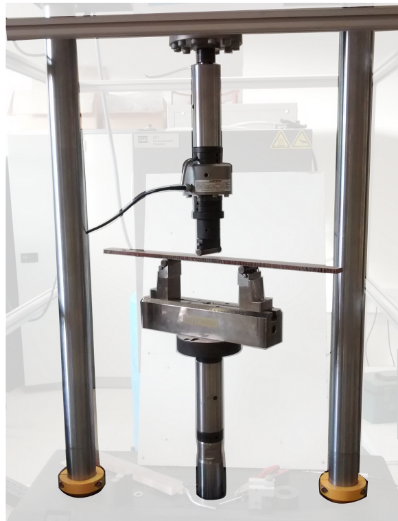
FIGURE 3.36 – Montage expérimental pour l’essai de flexion 3 points. La poutre est simplement appuyée sur deux cylindres, un effort statique P dont l’amplitude augmente progressivement est appliqué au centre de la structure, la flèche w est mesurée à la même position.
