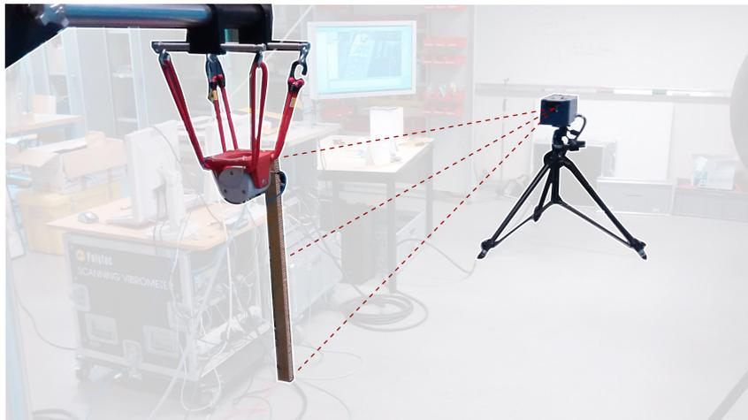
FIGURE 3.31 – Montage expérimental pour la mesure du champ de déplacement de la poutre sandwich NIDA. La structure est montée sur un pot vibrant en  $x_0 = 0.048$  m et un vibromètre laser à balayage mesure le champ de déplacement transverse.
