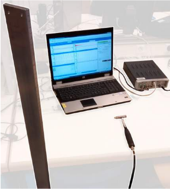
FIGURE 3.24 – Montage expérimental pour la mesure du champ de déplacement de la poutre épaisse en aluminium. Un marteau d’impact mobile sollicite la structure en différents points d’un maillage régulier. L’amplitude vibratoire est mesurée par un accéléromètre miniature.
