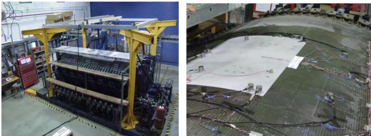
FIGURE 4 – Exemple d'essai structural en conditions industrielles représentatives de la réalité d'un cas de pressurisation instrumenté par des jauges et avec un suivi optique, acoustique et thermique [Leone et al. , 2008]
