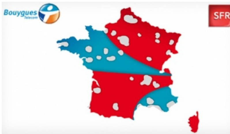
FIGURE 1.21 : Zones de déploiement du projet MOCN entre SFR et Bouygues Télécom dans le cadre du projet "CROZON".
