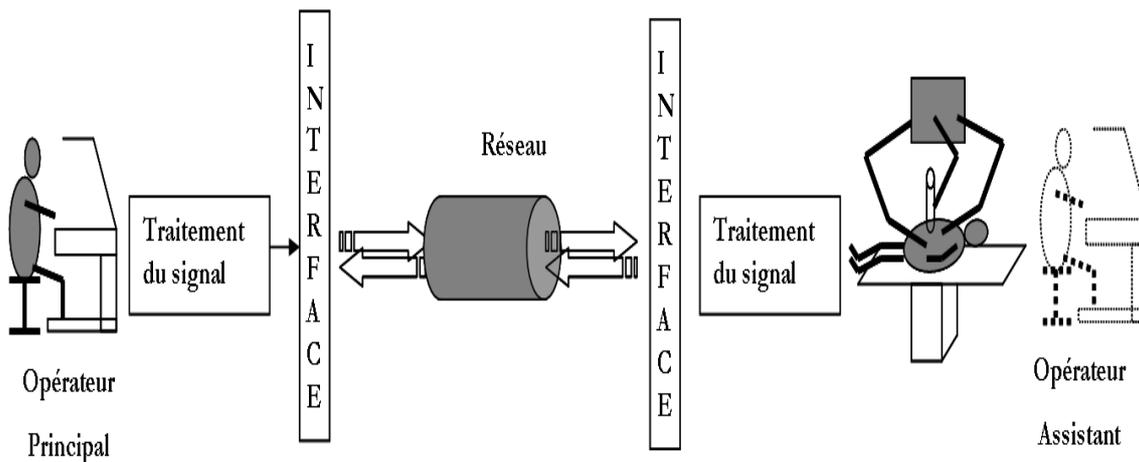
**FIGURE 1.8.** Principe de la téléchirurgie
