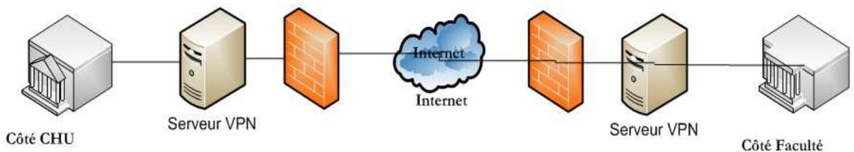
**FIGURE 5.3.** Principe d'un VPN entre deux sites
