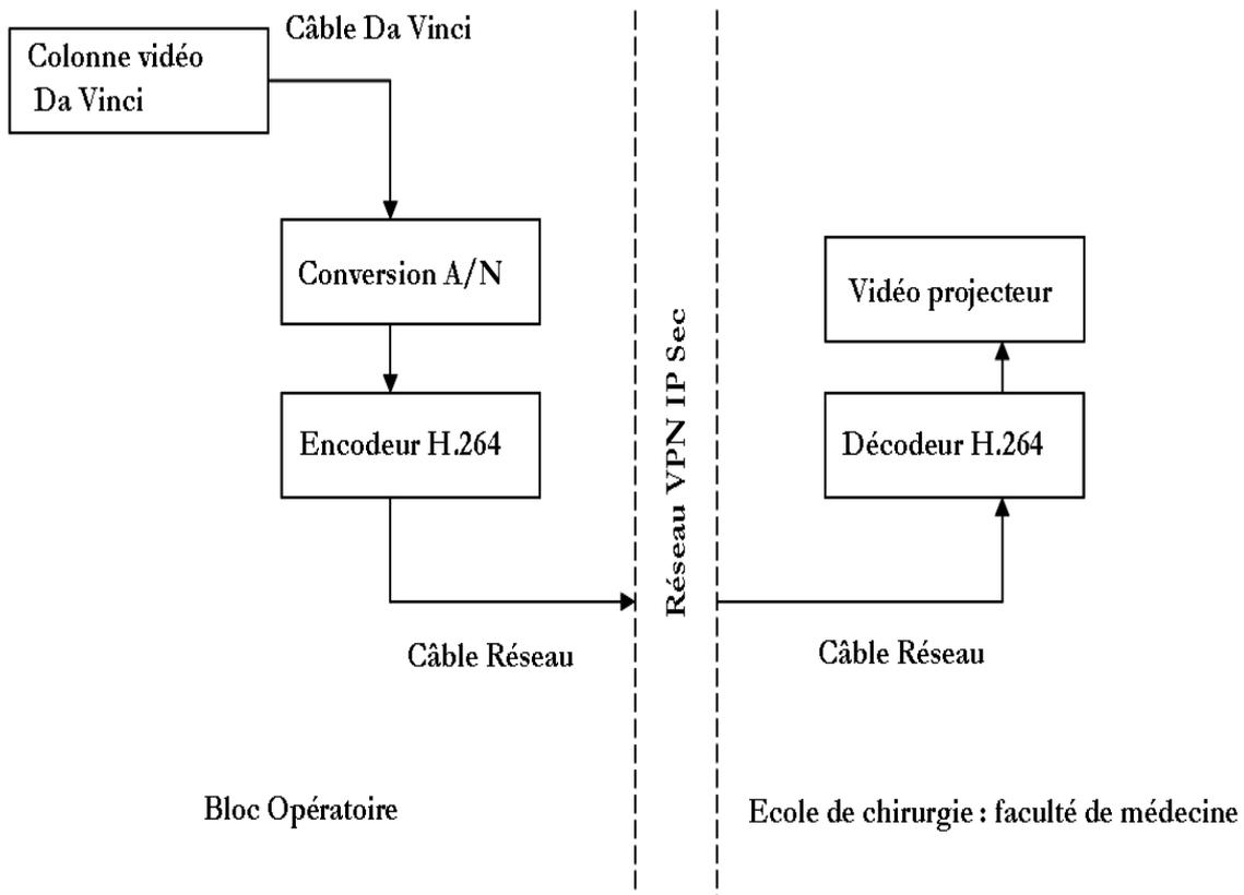
**FIGURE 5.2.** Schéma de transmission CHU vers Ecole de chirurgie
