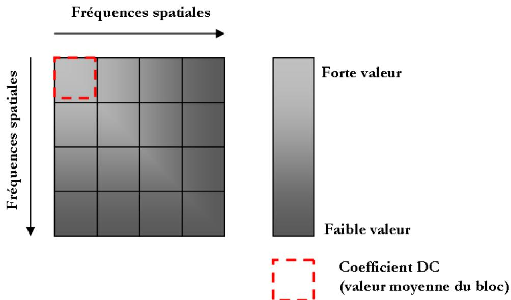
**FIGURE 2.2.** Transformation d'un bloc
