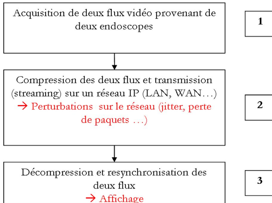
**FIGURE 5.1.** Schéma général de transmission des vidéos chirurgicales
