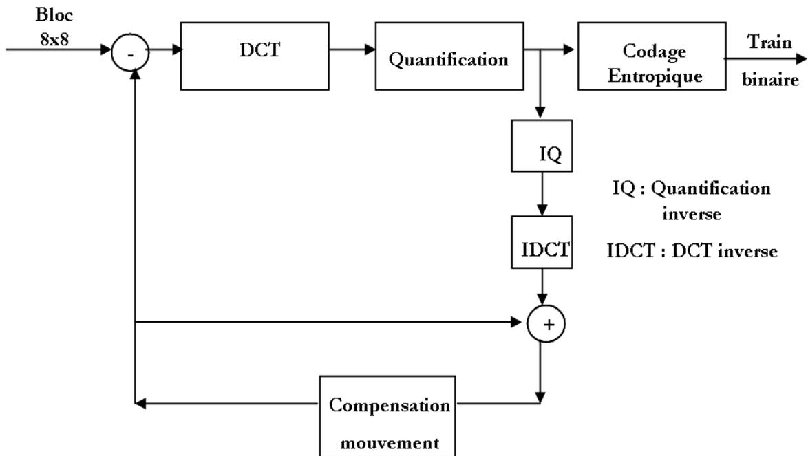
FIGURE 2.7. Encodeur MPEG-2
