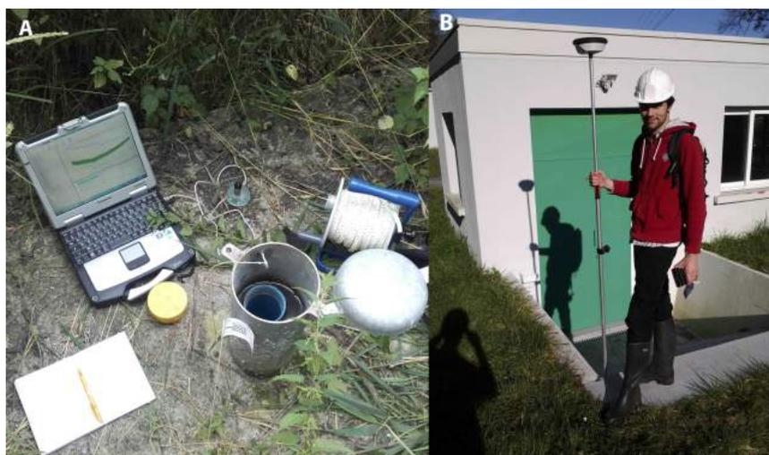
**Figure 4.9 :** A) Exemple de relevé de sonde DIVER dans un puits (P26) B) nivellement DGPS au abord du l’ouvrage R21
