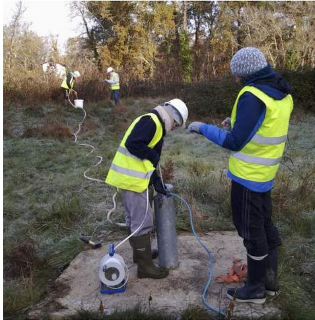
Figure 4.13 : Essai par pompage sur l'ouvrage P32
