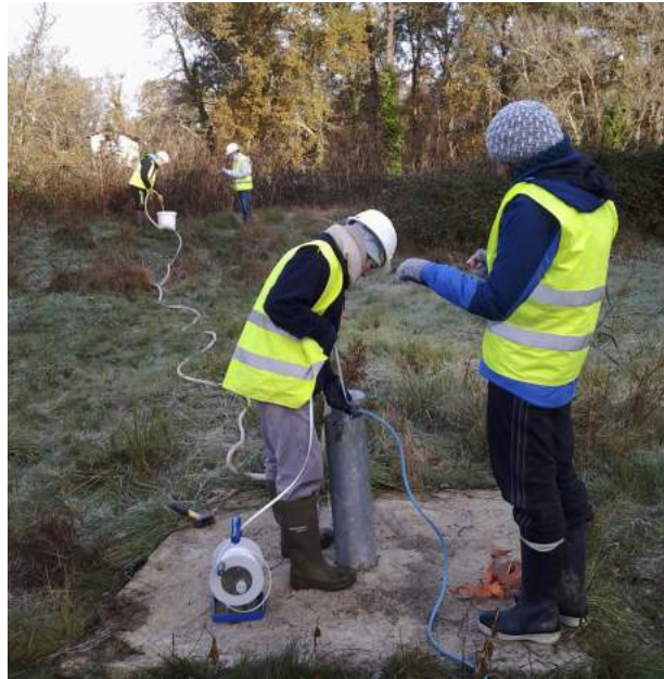
Figure 4.13 : Essai par pompage sur l'ouvrage P32
