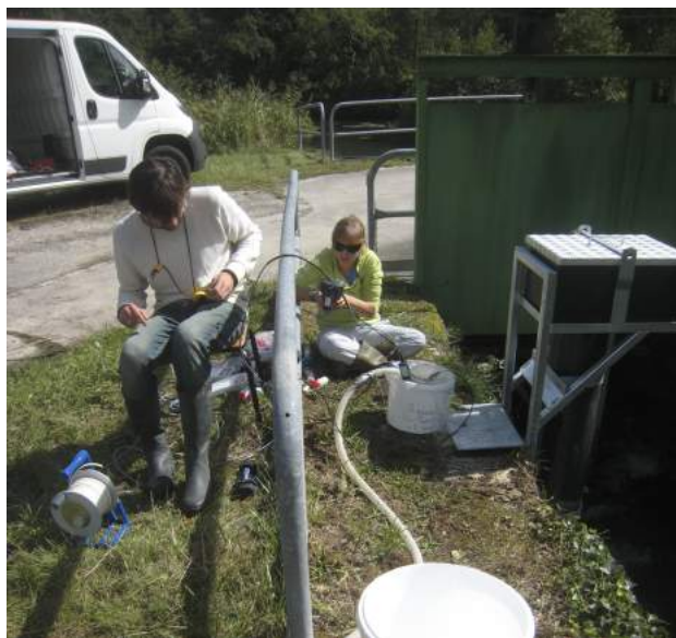
Figure 4.22 : Échantillonnage d'eau pour la mesure de la composition géochimique au niveau du seuil de la Jalle
