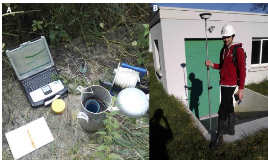
Figure 4.9 : A) Exemple de relevé de sonde DIVER dans un puits (P26) B) nivellement DGPS au abord du l’ouvrage R21
