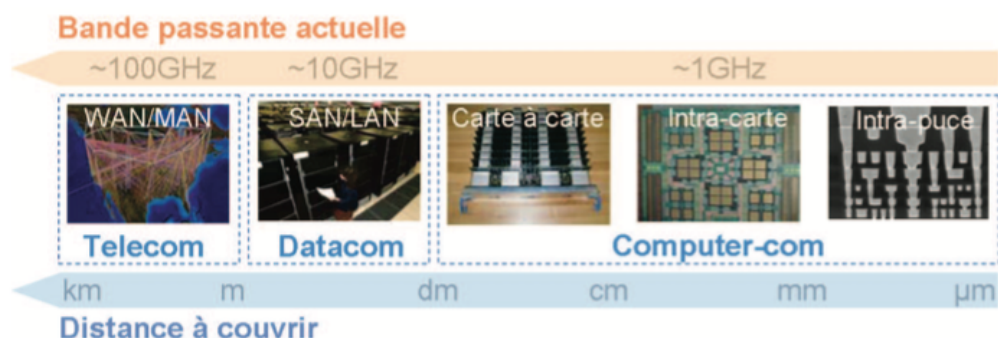
Figure 117 : Types d’interconnexions en fonction de la longueur du lien et de la bande passante nécessaire (Dupont, 2011)
