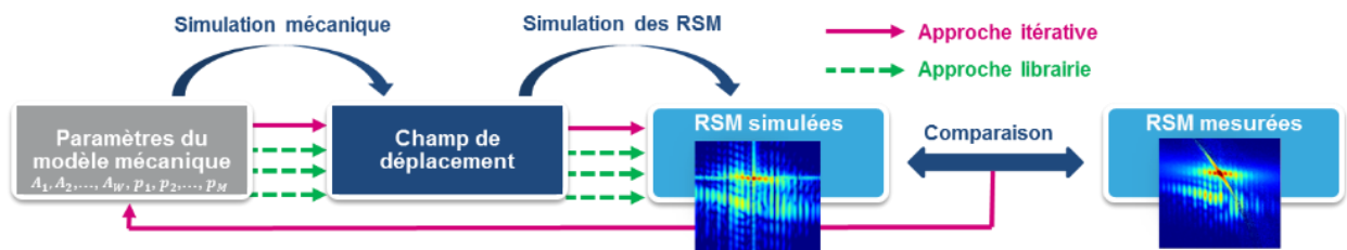
Figure 125 Schéma décrivant les étapes d'appariement d'un champ de déformation à une RSM mesurée par une approche itérative et une approche librairie
