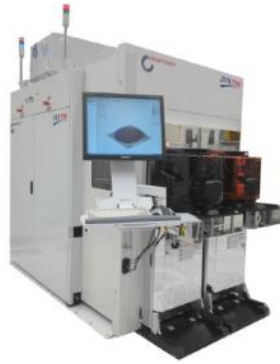
Figure 111 J VX7300, équipement HRXRD et XRR pour la métrologie des rayons-X en ligne.
