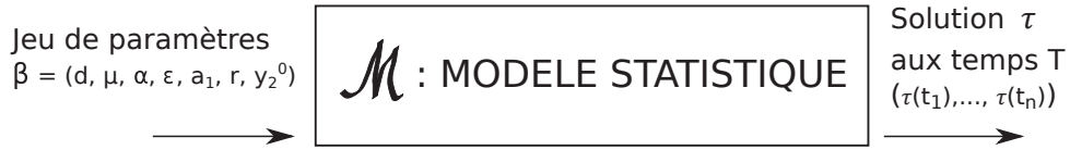
FIGURE 3.1 – Représentation schématique de l'application qui, à un jeu de paramètres, associe le vecteur composé de la deuxième composante de la solution aux mêmes temps que les données \bar{\tau} .
