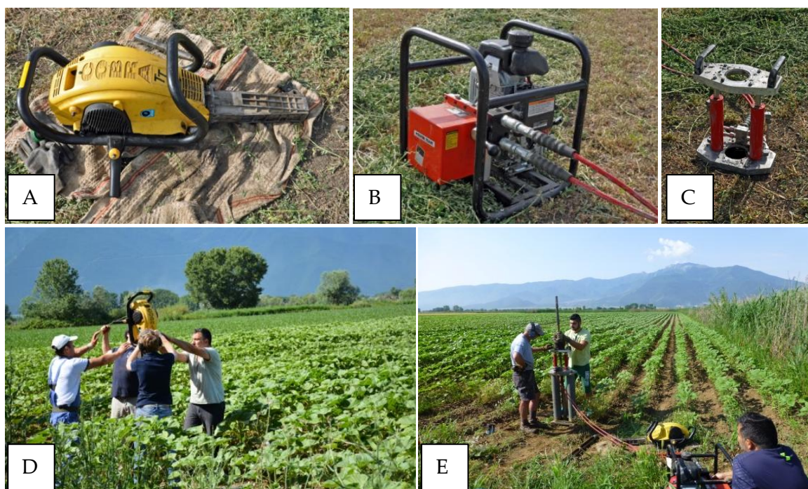
Figure 3.6 : Matériel de carottage. À : Carottier à percussion Cobra TT ; B et C : Extracteur hydraulique ; D : Opération de carottage (percussion) dans la plaine de Philippes-Drama sur le cône alluvial du Xéropotamos (mai 2015, LabEx Dynamite) ; E : Opération d'extraction d'une carotte dans la plaine de Philippes-Drama sur le cône alluvial du Xéropotamos (mai 2014, A. Glais).
