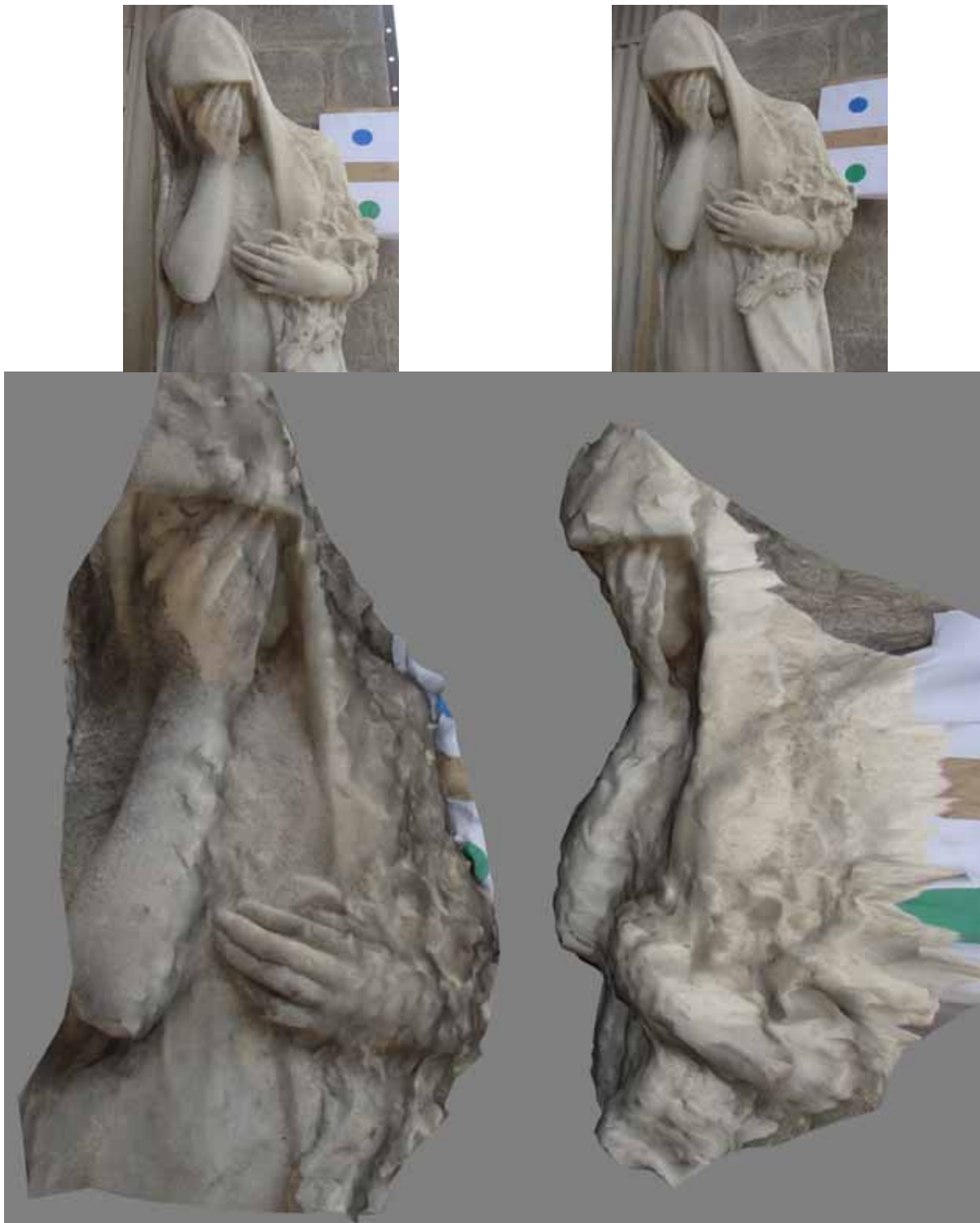
Figure 4.8 : Reconstruction d'une statue. En haut, paire d'images initiales, en bas, deux vues en perspective du modèle 3D obtenu par notre méthode.
