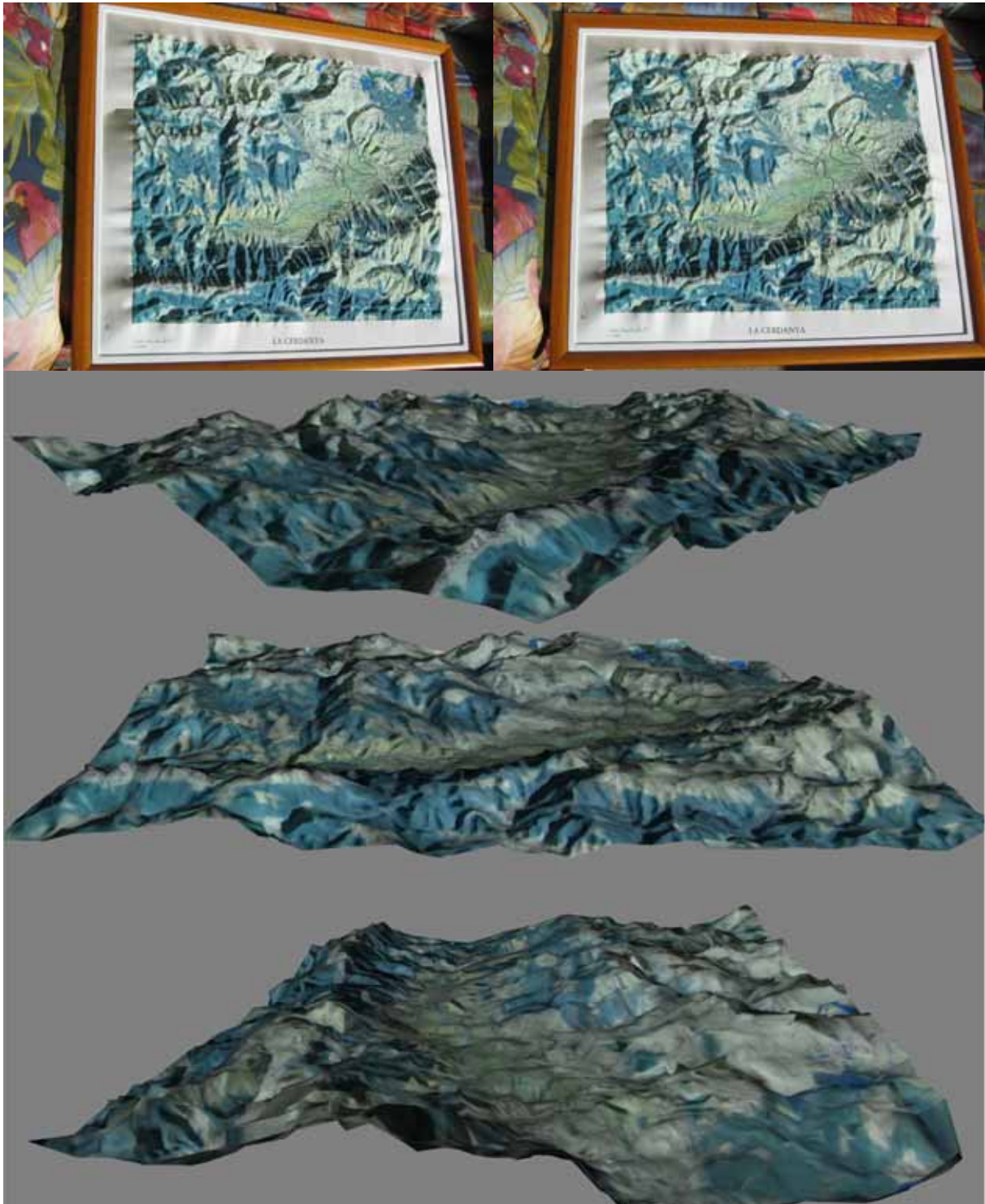
Figure 4.7 : Reconstruction d'une carte géographique en relief. En haut, paire d'images initiales, en bas, trois vues en perspective du modèle 3D obtenu par notre méthode.
