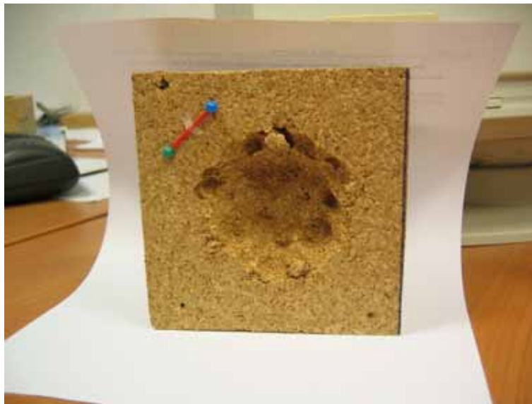
Figure 7.9 : Bloc de liège utilisé pour évaluer la précision volumétrique.
