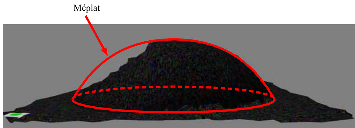
Figure 6.4 : Défaut de reconstruction lié aux occultations. Reconstruction obtenue par les images 1-19.
