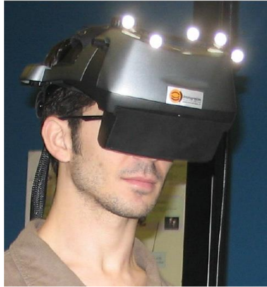
FIGURE 1.30 – Un visiocasque de Nvis avec accusation optique de la position de la tête, Nvis [2016]
