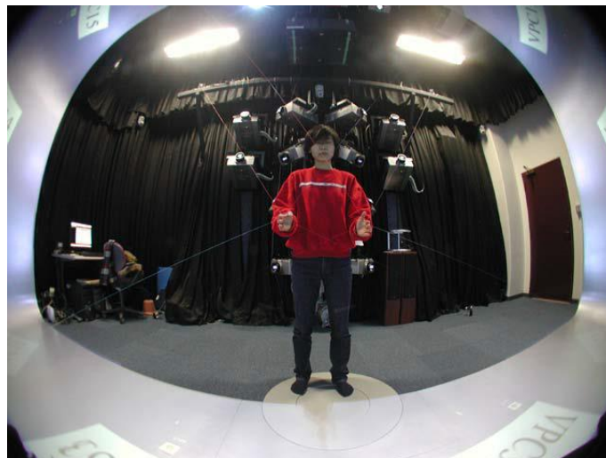
FIGURE 1.39 – L'interface à retour d'effort SPIDAR-H, HASEGAWA et collab. [2006]
