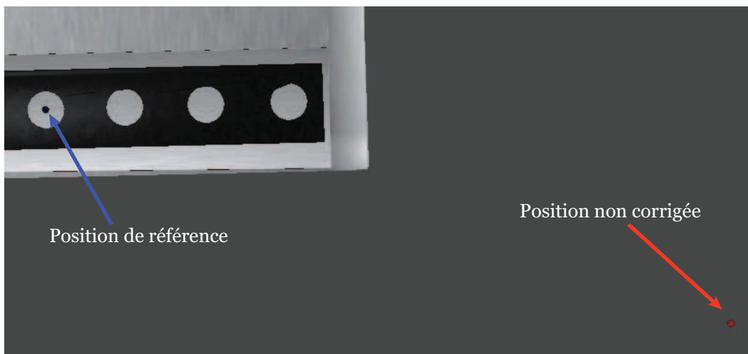
FIGURE 5.37 – Ecart entre la position de référence et la position mesurée par Scalable-SPIDAR avant calibration
