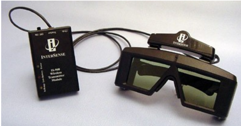
FIGURE 1.18 – Le système de tracking acoustique IS-900, [INTERSENSE, 1999]
