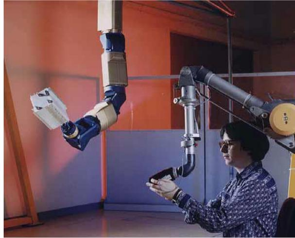
FIGURE 1.32 – Système maître-esclave pour la téléopération, [GOSSELIN \[2005\]](#)
