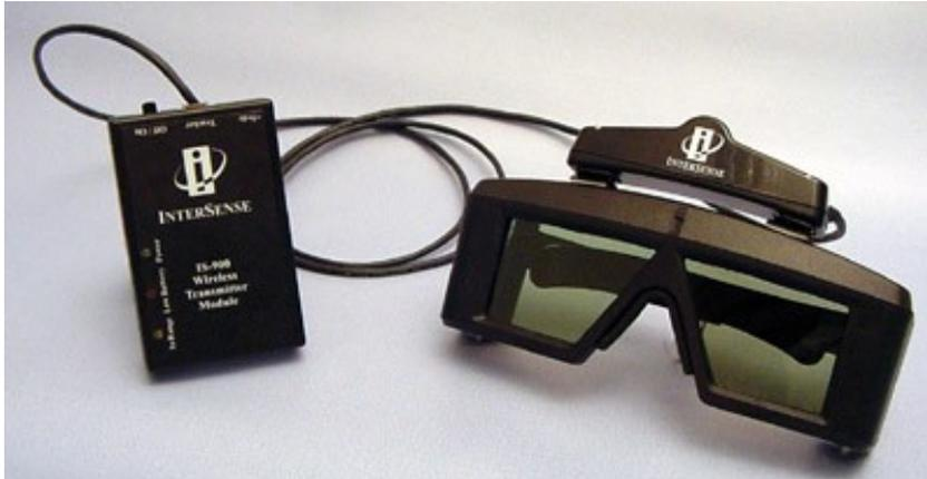
FIGURE 1.18 – Le système de tracking acoustique IS-900, [INTERSENSE, 1999]
